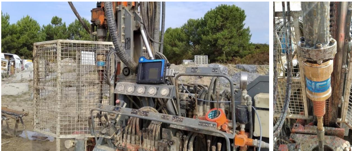
Figure 2 : Capteur installé sur une machine de forage utilisée pour la reconnaissance des sols
