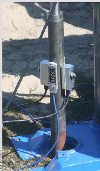
Contrôle de micropieu avec tripode et masses modulables. Les capteurs de mesure sont installés sur la tête du micropieu.
