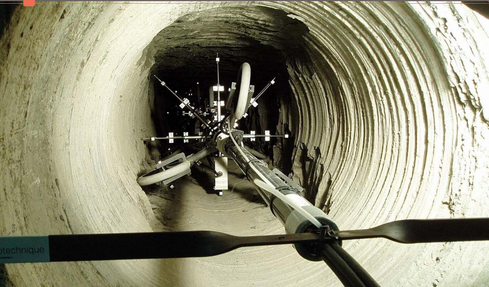
Dispositif de mesure de convergence en tête d'alvéole nue.
