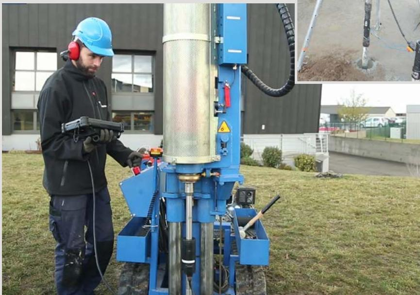
**Contrôle de micropieu avec machine de battage à énergie variable. Les capteurs de mesure sont installés dans la tête de battage.**
