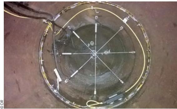
Mise en œuvre de capteurs fibre optique et traditionnels dans une alvéole du CMHM.
