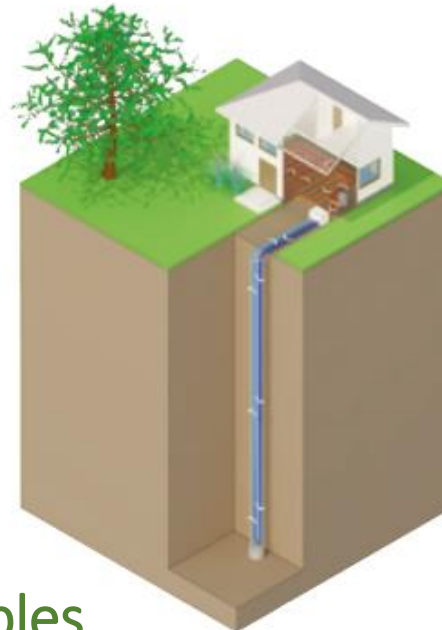
Sondes géothermiques verticales - © ADEME-BRGM
