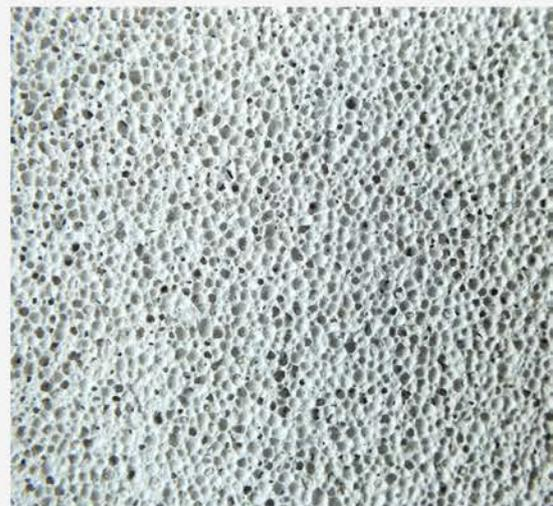
**Dans le génie civil, les entreprises utilisent le béton mousse AEROLITHYS® pour réaliser des remblais techniques (comblement de cavités ou de conduites, remblai à l'extrados des murs de soutènement, élargissement de chaussée, rehaussement de quai, etc.)**
