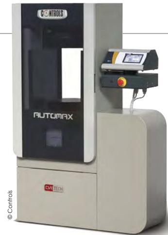
exposés : PAV (Pressure Aging Vessel) ; appareil bille et anneau automatique et pivot (pénétrömètre à bitume automatique). Enfin, Controls présente la machine de compression réputée Automax de 2 000 kN, comportant un bâti haute rigidité conforme à la norme EN, contrôlée par le système de commande et de contrôle automatique Automax.
