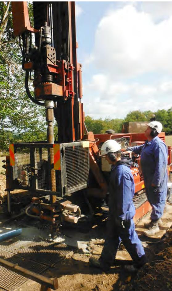
**Machine Hydrofore 1200 de 120 ch, conçue et réalisée dans les ateliers d'Hydrogéotechnique.**
