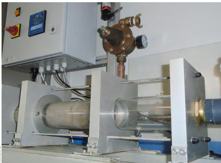
Dispositif pour la réalisation des essais d'érosion HET.
