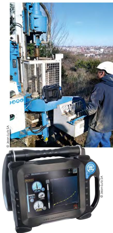
installés sur l'hydraulique de la sondeuse.
