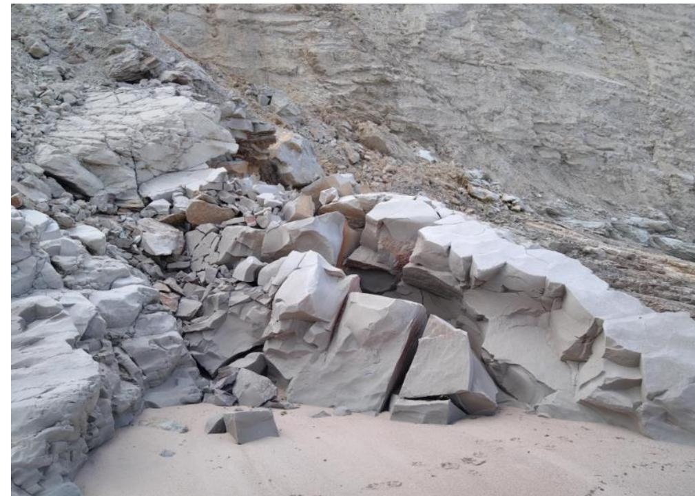
Détachement puis décomposition d'un **volume rocheux** « conséquent » principalement par pressions d'eau
