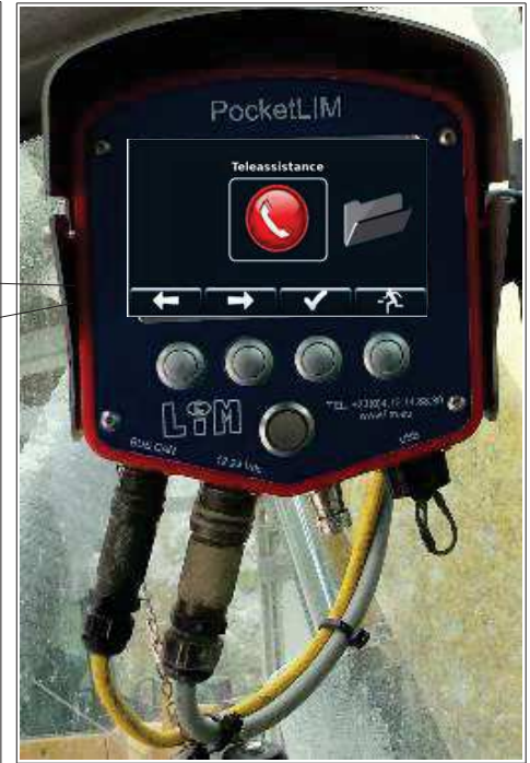
Système connecté PocketLIM installé dans une cabine de foreuse.
