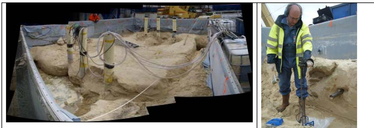
Figure 11 Essais Conteneur Papendrecht (NL) – vue du massif calcifié après ouverture du plot
