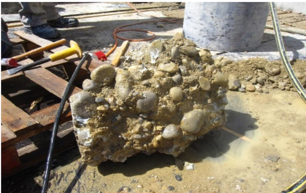
*Figure 14 : Bloc calcifié de Biocalcis, issu d'un carottage en grand diamètre*
