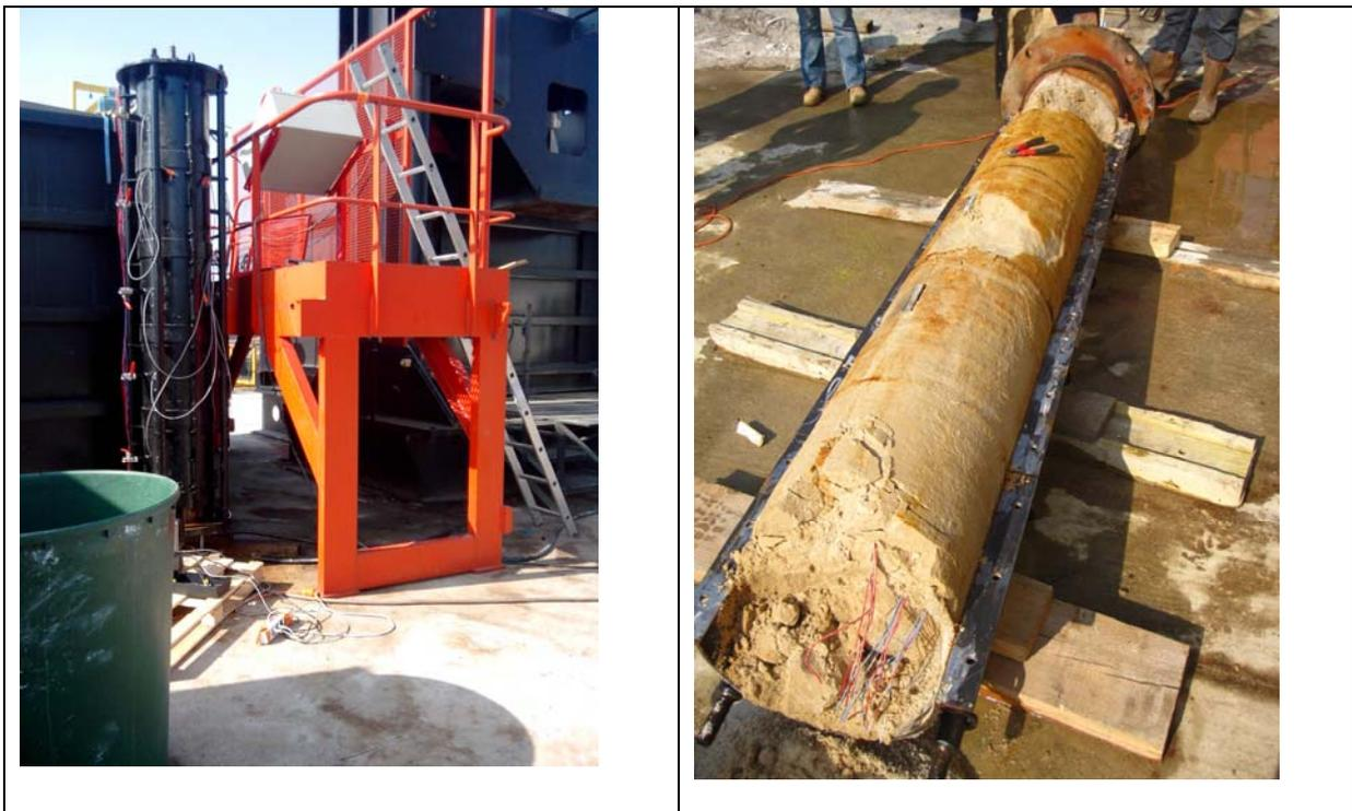
*Figure 12 Essais Colonne 2,5 mètres – dispositif et colonne calcifiée après ouverture*
